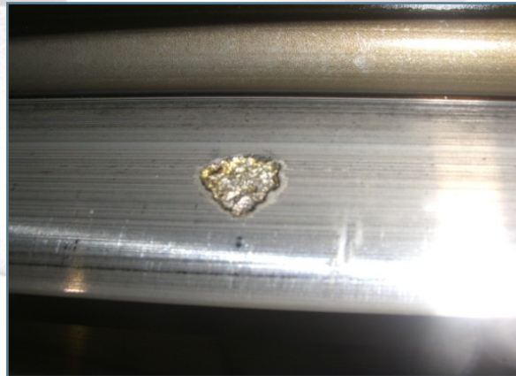
Pittings und Ausbrüche
